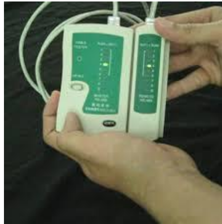
Gambar 3.19 Pengetesan kabel UTP dengan LAN Tester
